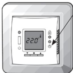
Du kan gå inn i innstillingene ved å trykke på ⌚ knappen med en liten skrutrekker eller penn. Nå endrer displayet seg fra temperaturvisning til visning av klokkeslett.
